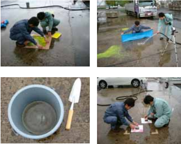
写真：岸壁実験の様子(上左：塗料の塗布, 上右：放水, 下左：作成した汚水, 下右：ふき取り)
