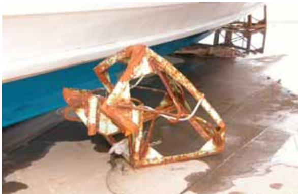
写真-2 座屈した架台(H15 十勝沖地震)
