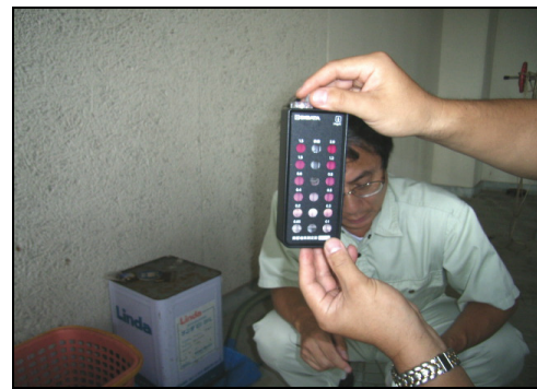
写真-1 DPD比色法による残留塩素測定
