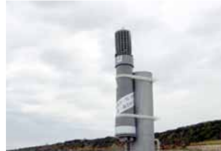
写真-1 捕塩器設置状況
