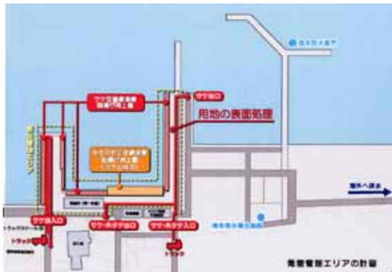
図-7 標津漁港における環境・衛生管理型漁港計画（標津町地域 HACCP との連携を図り、上屋施設の整備、泊地浚渫、港内の用地の表面処理といった漁港整備が進められている。）
