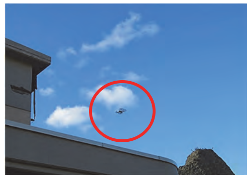
写真-4 排気塔の壁のコンクリート劣化状況を撮影するため飛行する小型ドローン
