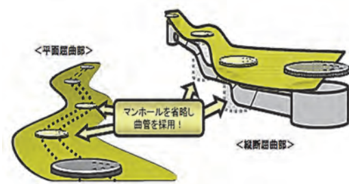
図-12 ポリエチレン管の特徴(施工の柔軟性)
