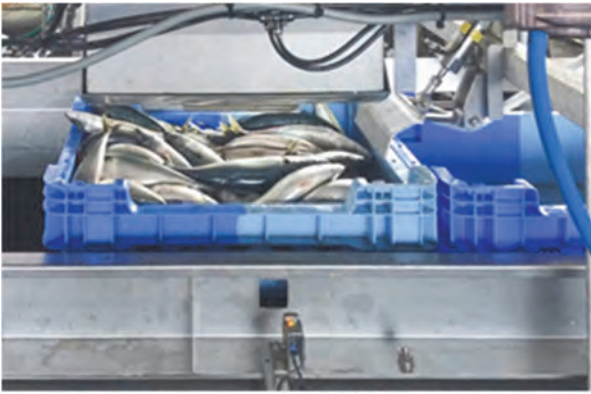
写真-3 定貫投入機の導入
