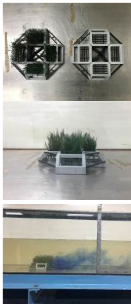
図-5 水理実験模型と染料投入による流れの可視
