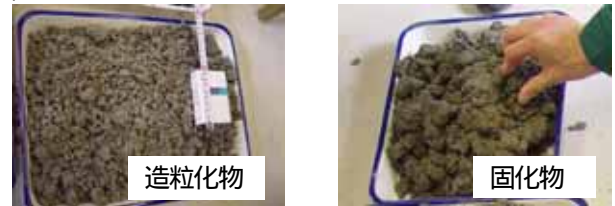
写真-3 プラントによる出来形性状
